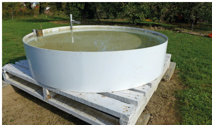
1. ábra. „A” típusú párolgásmérő kád.
